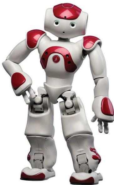
Sa vedette appartient à la planète SF, elle s'appelle Nao et c'est un charmant robot qui mesure 58 centimètres, porte une combinaison de travail bleu gris, dont les yeux sont rouges, les « cheveux » (en fait juste une coque sur sa tête blanche) sont bleus ou rouges. Grâce à ses 9 capteurs tactiles et à ses 25 articulations, il « smurfe » et « break-dance » comme un hip-hopeur expérimenté,
